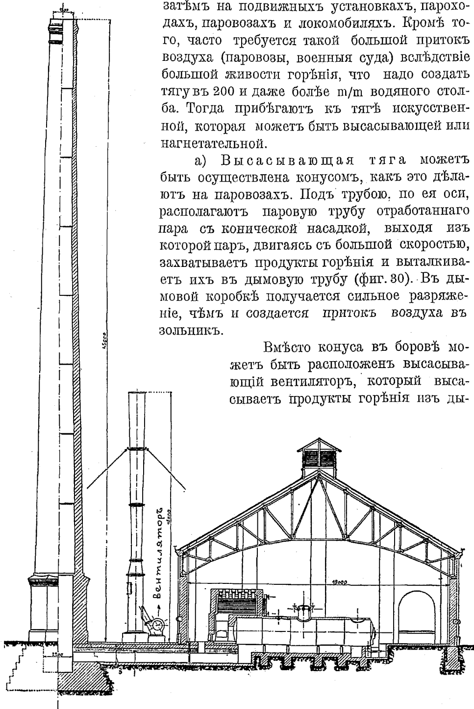
Фиг. 29. — Сравненіе дымовой трубы и искусственной тяги помощью высасывающаго вентилятора.
